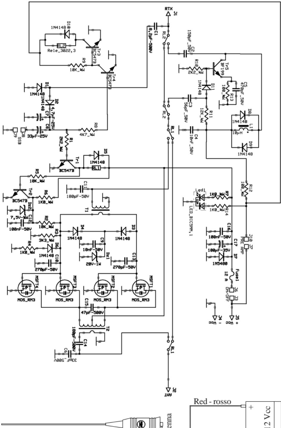
Il cavo di alimentazione deve essere inferiore ai 3 m. possibilmente collegato direttamente alla batteria e di sezione non inferiore a 2 mm<sup>2</sup>.
