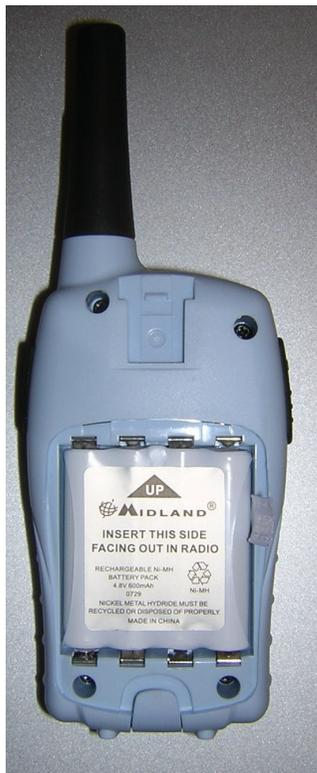
Zuerst nehmen Sie bitte den Gürtelclip ab (an der Feder ziehen und Clip nach oben schieben) und öffnen Sie den Batteriedeckel (Klammer nach unten ausrasten lassen und Deckel abnehmen).
