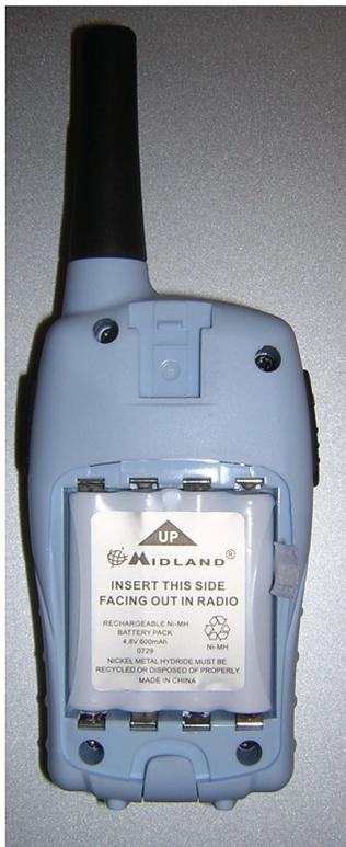
Enlever le clip ceinture (tirez la languette et retirez le haut) et ouvrez le logement de la batterie.
