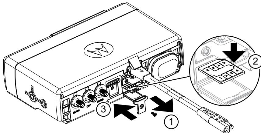
4 ドライバを使用して SIM カード スロットをネジで固定します。
