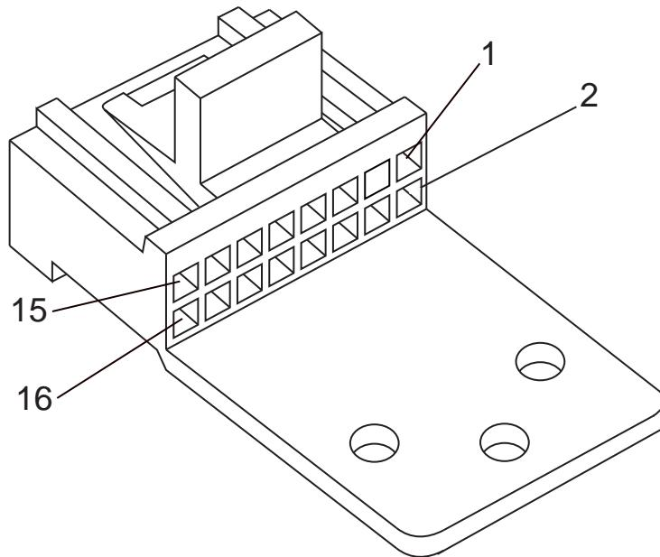
Figure 19 : Configuration des broches du connecteur d'accessoires arrière (vue arrière de la radio)
