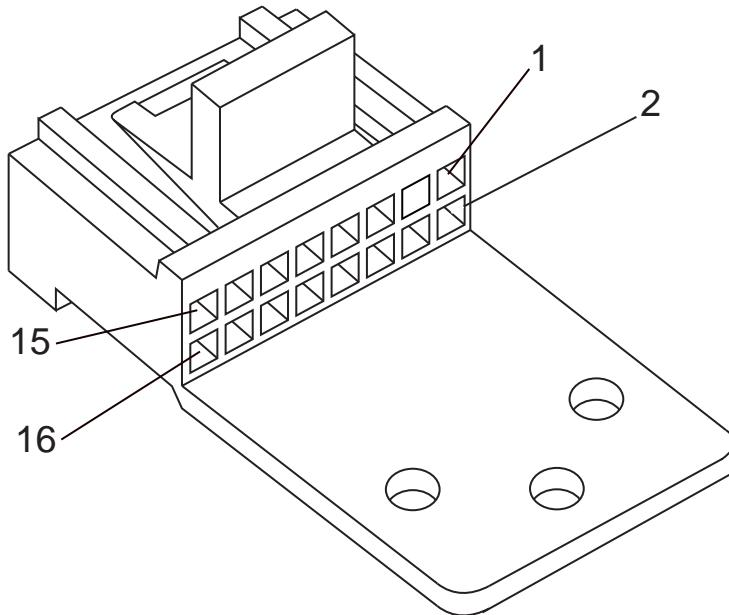
図 19: 背面アクセサリ コネクタのピン接続 (無線装置の背面から見た図)
