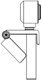
Befestigen Sie die Halterung der Kamera auf der Oberkante Ihres Monitors in dem Sie den unteren Teil der Halterung gegen die Rückseite des Bildschirmes drücken.
