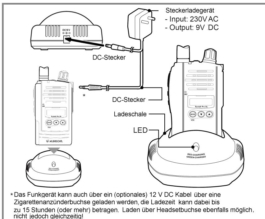
\* Das Funkgerät kann auch über ein (optionales) 12 V DC Kabel über eine Zigarettenanzünderbuchse geladen werden, die Ladezeit kann dabei bis zu 15 Stunden (oder mehr) betragen. Laden über Headsetbuchse ebenfalls möglich, nicht jedoch gleichzeitig!
